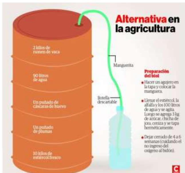
Ilustración 4 Biodigestor.
