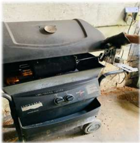
Figura 6 Tostadora utilizada en Finca Magdalena para realizar el tueste medio del café, donde se controla cuidadosamente el tiempo y la temperatura del proceso.
