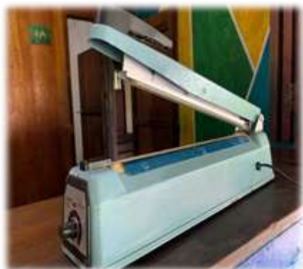
Figura 8. Sellador térmico empleada para asegurar el sellado hermético de los empaques de café orgánico tostado en Finca Magdalena en la comunidad de Balgüe, isla de Ometepe, Rivas Nicaragua.
